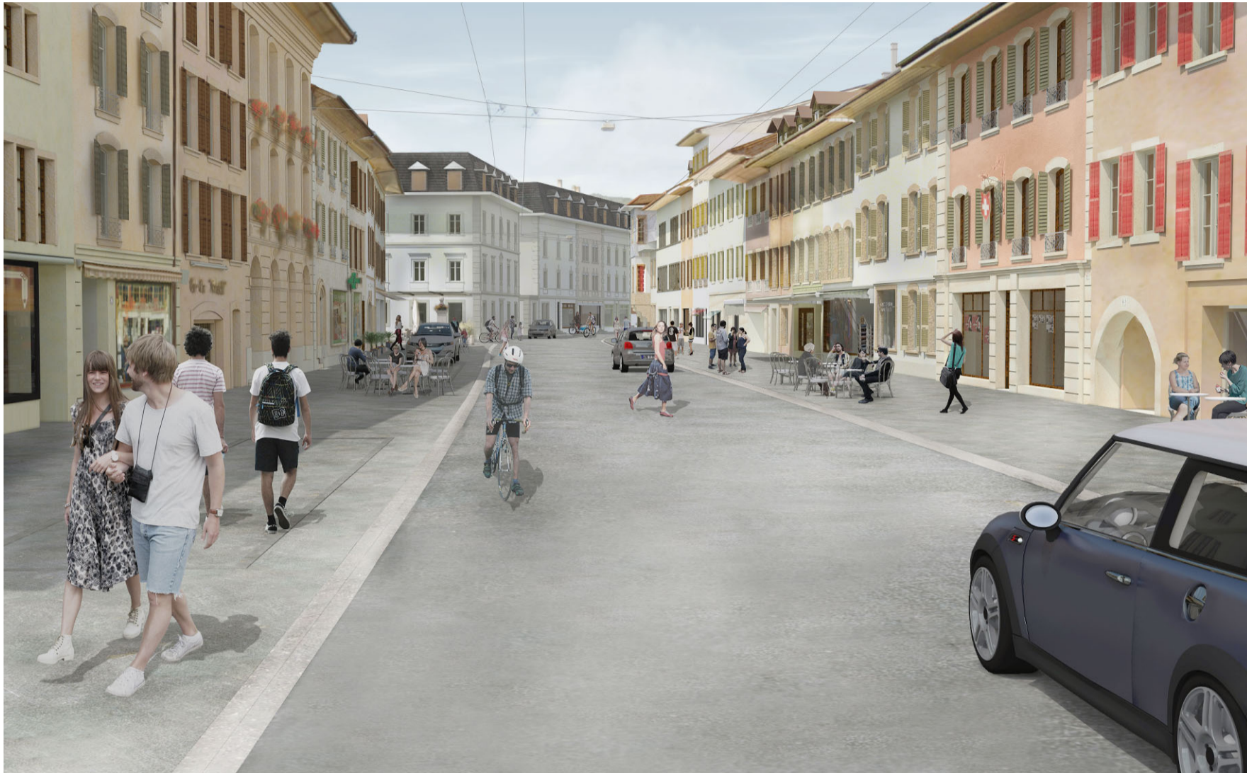
Genügend Raum für alle von Fassade zu Fassade: So stellen sich die Planer Nidaus innerstädtische Zukunft vor. Ein bei der aktuellen Verkehrsbelastung allerdings kaum realistisches Szenario. Gut zu sehen sind die «weichen» Randsteine, die Nutzflächen mit Tischchen und Stühlen und das flächige Queren der Strasse. Visualisierungen: Roduner BSB + Partner AG/zvg
